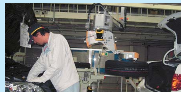
人と隔離されずスペアタイヤを搭載するロボット
